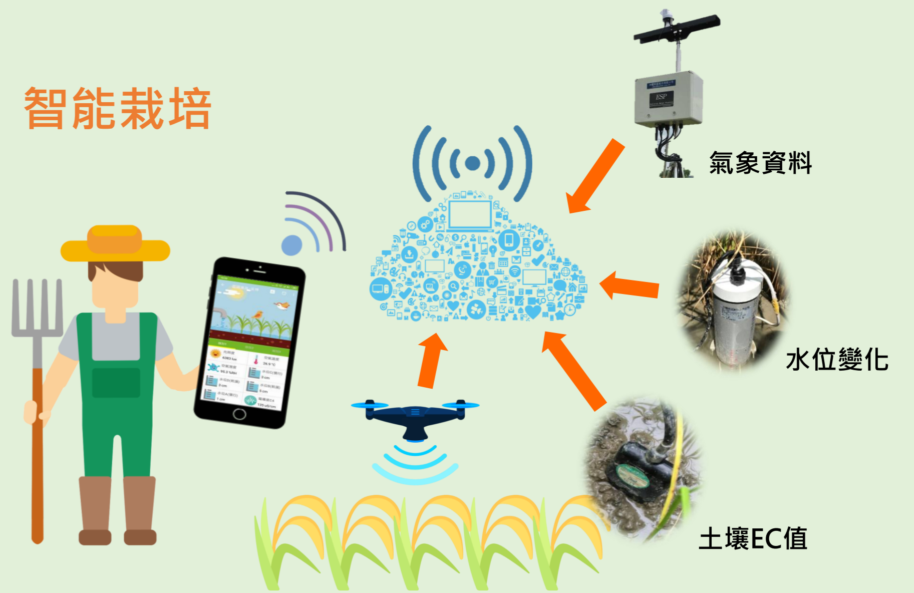
圖二、智慧農業概念圖：通過智能傳感器與手機APP連結，可即時接收田區資訊。
